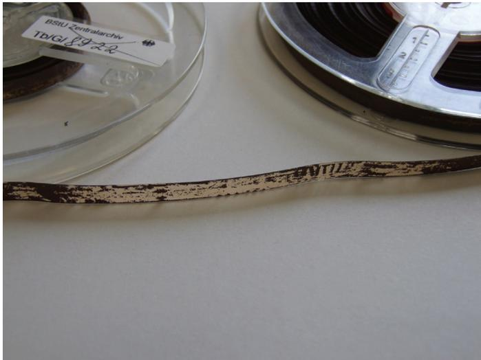
Abb. 2: Tonband mit Schichtablösungen
