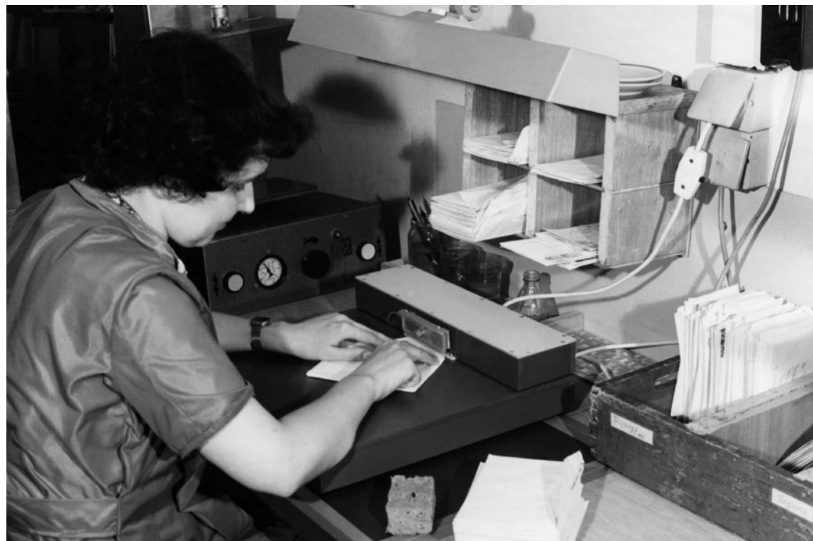
> 1986 entwickelte das MfS ein halbautomatisches Gerät zum Verschließen geöffneter Postsendungen. »Die »HSM 86« wird unseren Anforderungen gerecht«, befanden die sächsischen Postkontrolleure. 1987 BStU, MfS, BV Karl-Marx-Stadt, Abt. M, Nr. 4, Bl. 20
